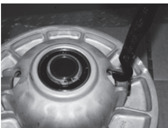
Hakenende des Werkzeugs einführen.
